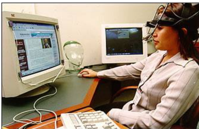
Ilustração 10: Equipamento usado para monitorar o movimento dos olhos de leitores de jornais na Web (LEWENSTEIN, 2000)
